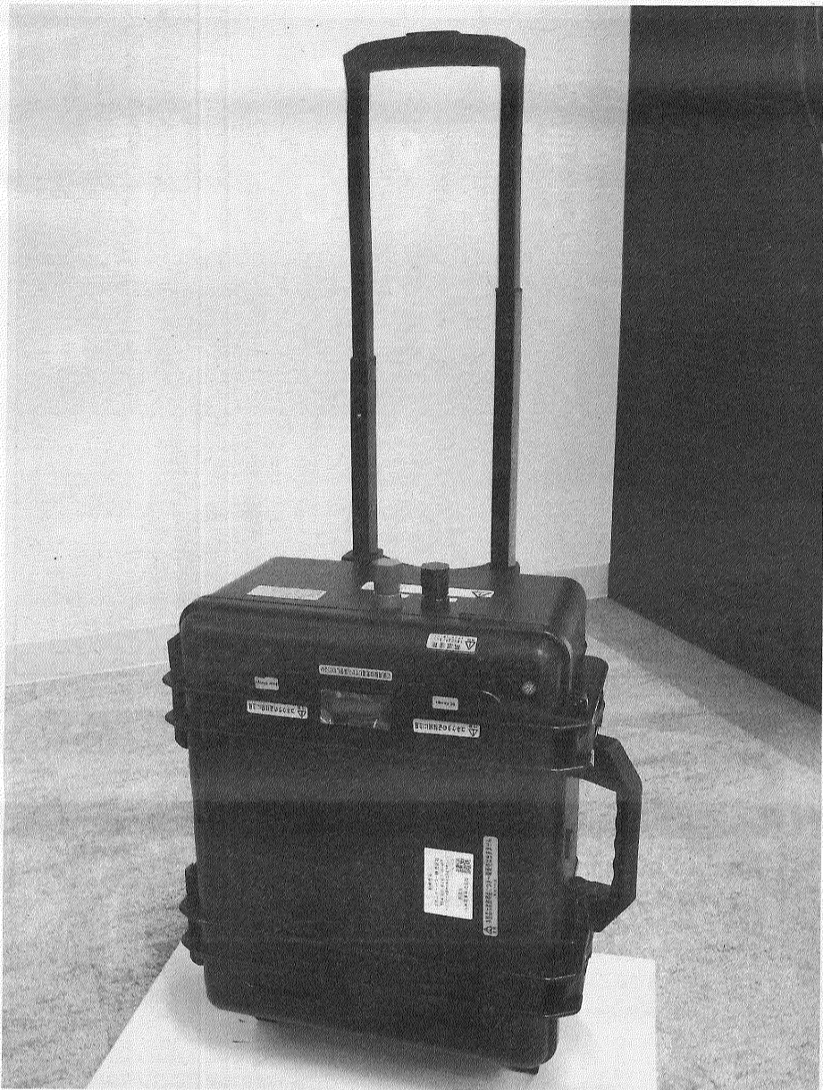
エネルギーパワーが開発・販売を始めた蓄電池「どか電」。持ち運びがしやすいよう、スーツケースのようにキャスターや引き伸ばしができるハンドルを付けた。蓄電池本体の故障はほとんどない(同社)と。経年劣化は年3%程度で、10年後の蓄電能力は7割を維持。1時間充電して1時間放電する急速充電の場合で1000回使用できるが「通常の使用であれば、2000~3000回は大丈夫」としている。蓄電能力は低く、2000回を超えても使用できないわけではない。充電時間は家庭用コンセントで約10時間、別売りのソーラーパネルで夏場なら15時間ほどになるという。自然放電は年10~15%程度で「年に1回は充電してもらえばいい」(同)。
